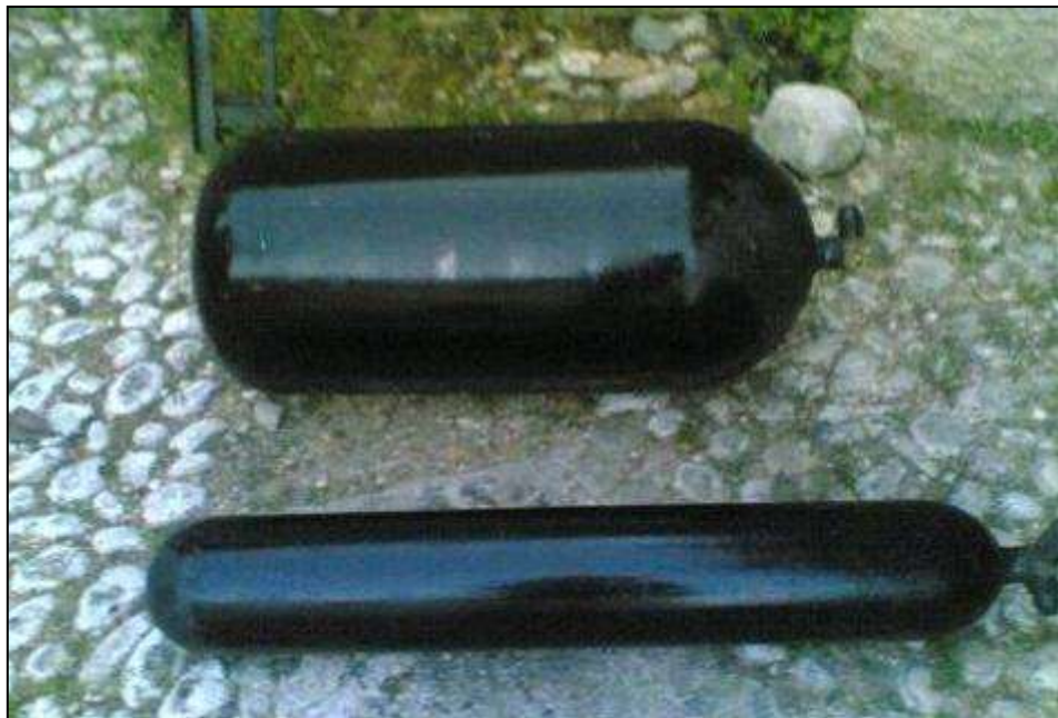
Serbatoi di metano compresso
