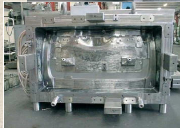
Parte mobile (matrice) e parte fissa (punzone) di uno stampo per iniezione termoplastica del rivestimento interno dello sportello baule per un'auto.
